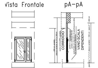
Pr-1: PARTICOLARE CAVEDIO A PIANO RIALZATO DA DEMOLIRE E RICOSTRUIRE DOPO LA REALIZZAZIONE DEL SETTO TRAMEZZO-VETRATE
