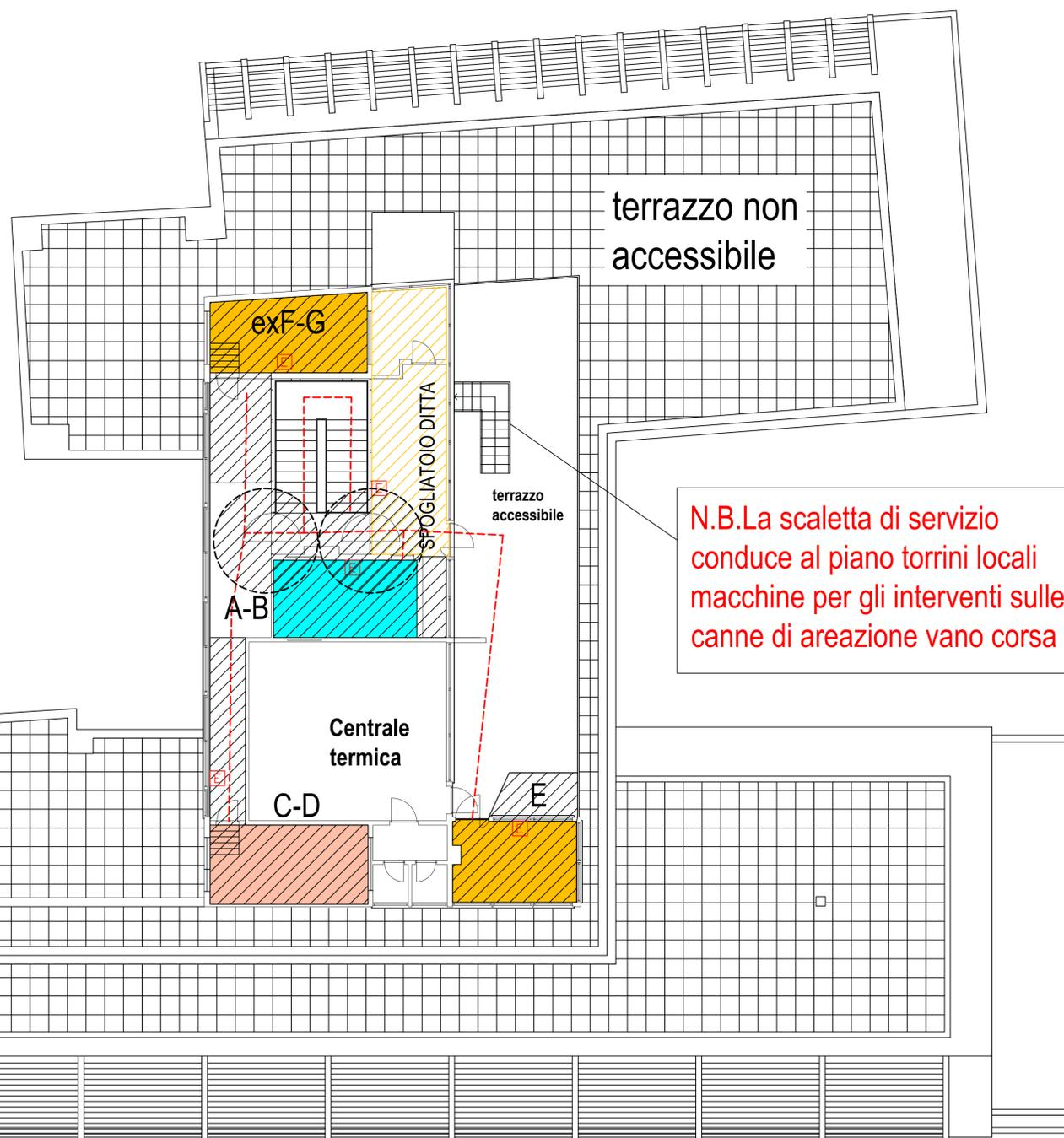
**N.B. La scaletta di servizio conduce al piano torrini locali macchine per gli interventi sulle canne di areazione vano corsa**
