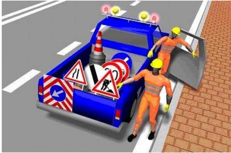
Descrizione: prima fase accantieramento stradale
