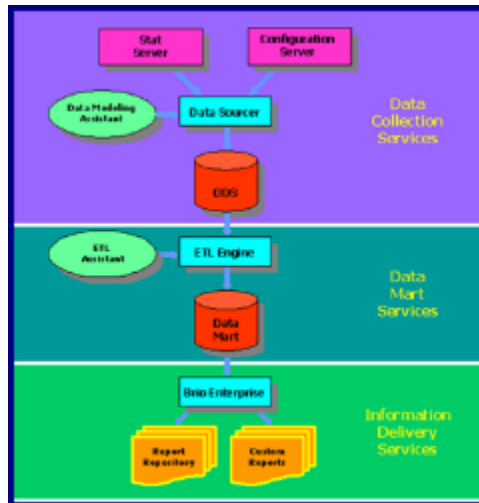
Figura 43 - Architettura CC Analyzer
