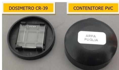
Figura 1a. Immagine del CR-39 e del contenitore in PVC.
