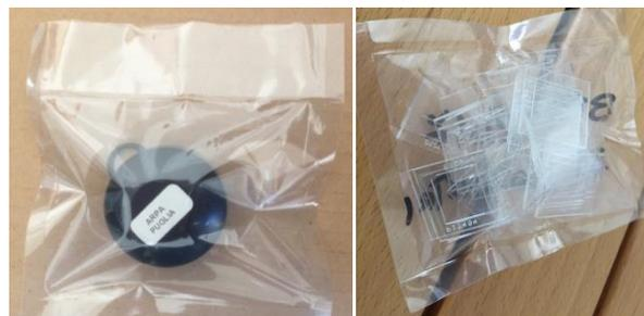
Figura 1b. CR-39 in busta impermeabile al radon.
