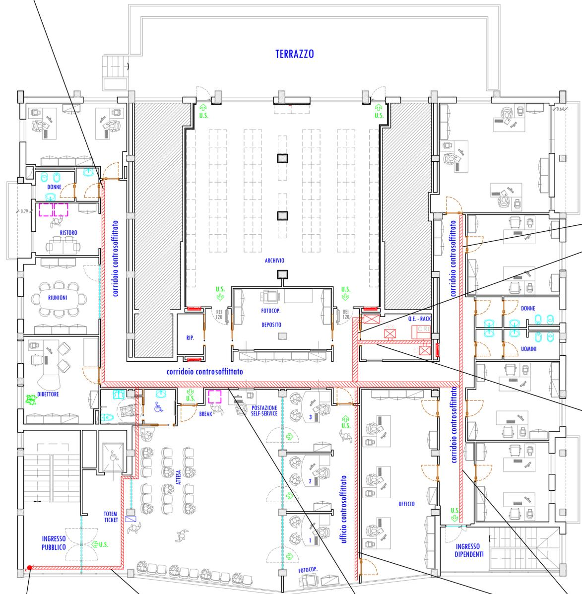
Passerella a rete metallica 300x50 mm con separatore energia/segnali, (200-100) in controsoffitto origine da quadri elettrici/dati
