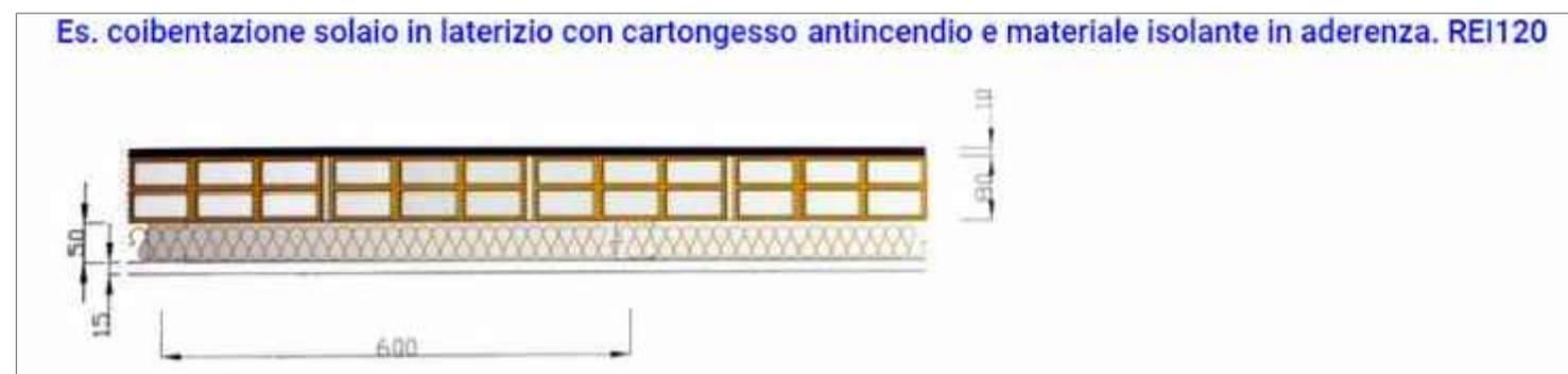
"A" "Dettaglio indicativo" CONTROSOFFITTO in aderenza solaio
