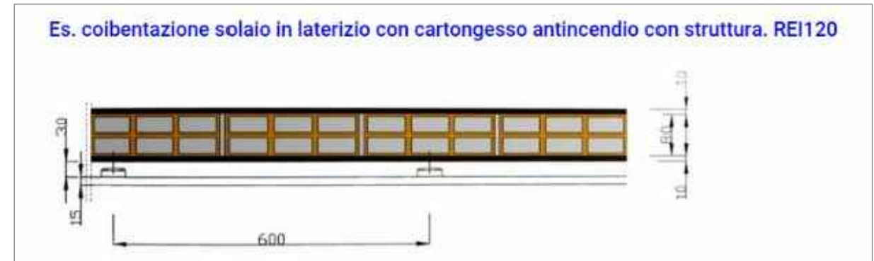
"B" "Dettaglio indicativo" CONTROSOFFITTO con struttura REI 120
