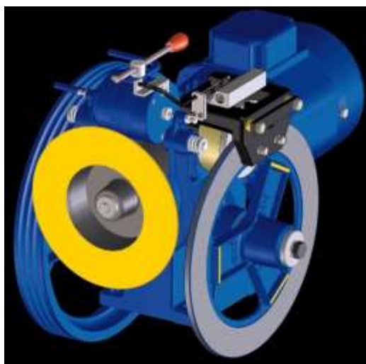
Figura 01 Argano con dispositivo contro i movimenti incontrollati
