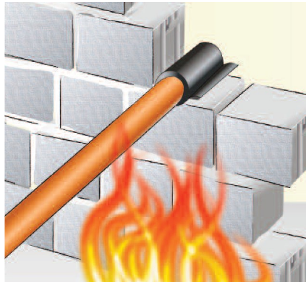
SOLUZIONE - B - ATTRAVERSAMENTI DI TUBI IN MATERIALE PLASTICO DI MURI O SOLAI CON NASTRO INTUMESCENTE EI120 NASTRO 100X8mm PER TUBI FINO A Ø 75mm E NASTRO 100X12mm PER TUBO Ø FINO A 120mm, CODICE A05.5.15.093 DELL'ELENCO PREZZI
