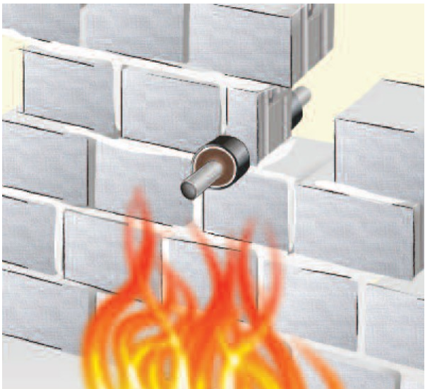
SOLUZIONE - C - ATTRAVERSAMENTI DI TUBI IN MATERIALE METALLICO DI MURI O SOLAI CON FELTRO SPESSORE 40mm, PER TUBI CON Ø ESTERNO FINO A 200mm, DOVRA' ESSERE APPLICATO AVVOLGENDO LA TUBAZIONE PER UNA LUNGHEZZA DI 300mm SU ENTRAMBI I LATI E TENUTO IN POSIZIONE CON FILO D'ACCIAIO CON PASSO 100mm, CODICE AP28 DELL'ELENCO PREZZI
