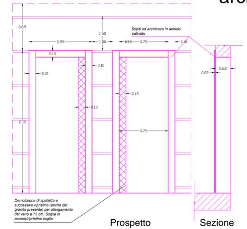
**Dettaglio opere edili vano ascensore (d) rapp. 1:20**
