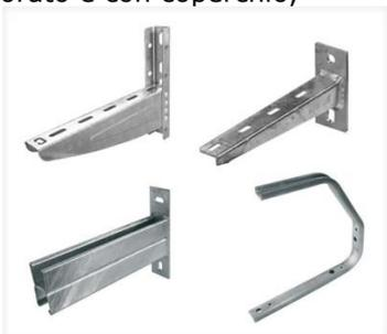
le staffe, i supporti ed i sistemi di fissaggio da utilizzare per la collocazione di canali o di collari per i tubi dovranno essere di tipo standardizzato e costruiti per lo specifico scopo, le staffe dovranno essere collocati ad una distanza massima di 1,5m e comunque nei cambi di direzione
