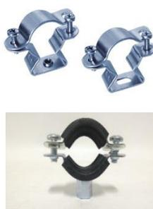
i collari per l'ancoraggio dei tubi metallici dovranno essere del tipo indicato in figura, idonei per il fissaggio a muro o su staffe, dovranno essere collocati ad una distanza massima di 1,5m e comunque ad ogni cambio di direzione
