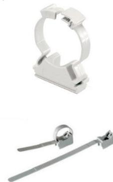
Per i tubi in PVC sarà ammesso esclusivamente l'utilizzo di collari chiusi, per la distanza di fissaggio si dovrà rispettare il passo max di 1,5m e del cambio di direzione
